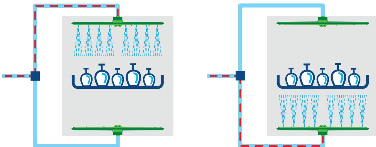
Le rinçage séquentiel permet d'utiliser l'eau où et quand elle est nécessaire, en la concentrant dans les zones les plus difficiles à rincer et en la réduisant dans les zones accessibles. L'action mécanique de l'eau augmente, ce qui favorise l'élimination de l'eau, la solution détergente des zones stagnantes telles que le fond des tasses et des verres. En outre, grâce au rinçage séquentiel, **le lave-vaisselle fonctionne avec une pression d'alimentation en eau réduite de 20%.**
